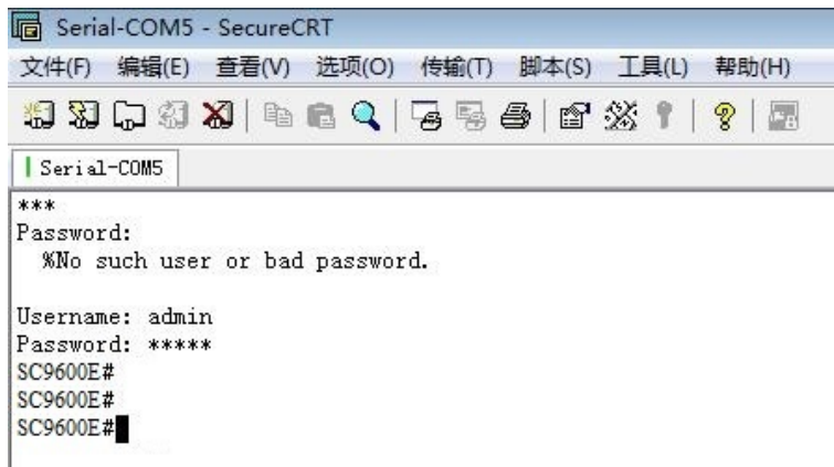
图 1-10 Console口方式登录SC9600E高端交换机
