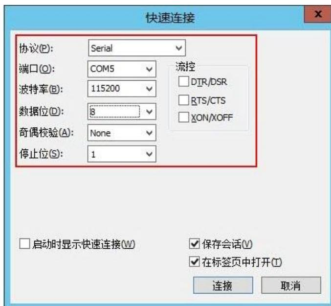
图 1-2 设置 CN12800 的端口和串口属性
